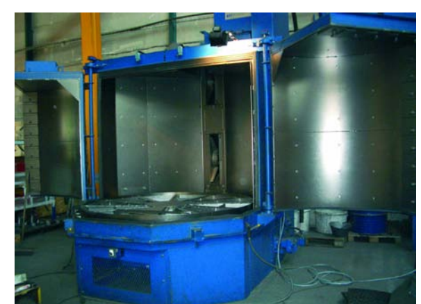
Préparation de surface Shotblasting
